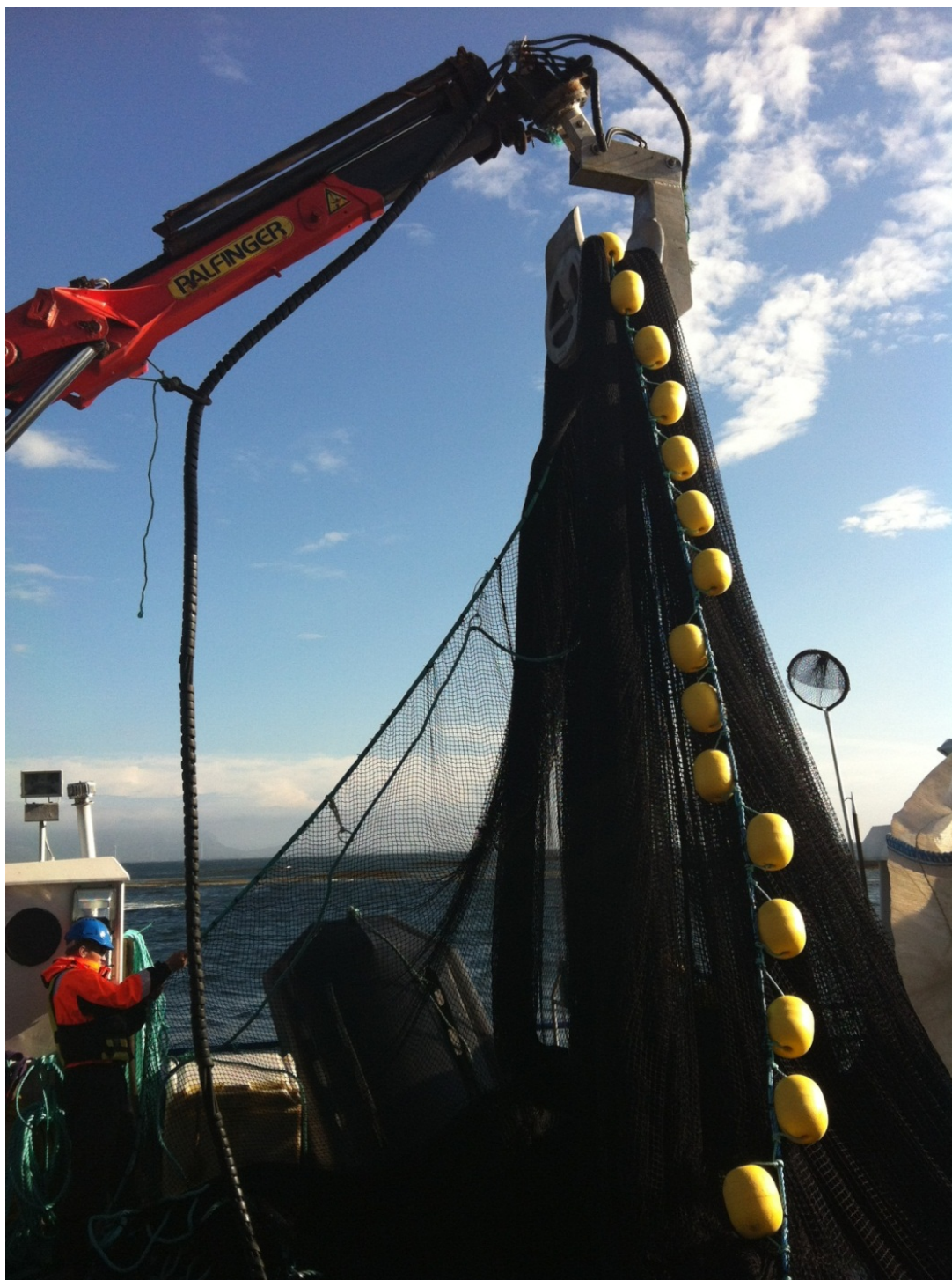
Bilde 1 Håndtering av not med kran.
